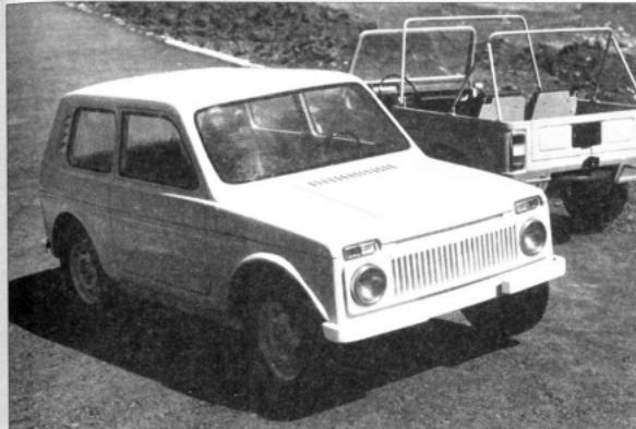
Альтернативный макет (1:5) закрытого цельнометаллического варианта. На заднем плане — макет прежней, открытой концепции джипа
