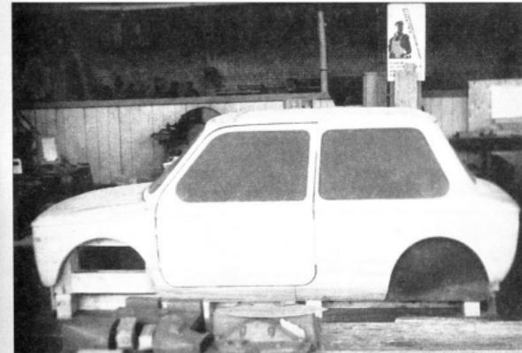
Деревянная модель Э1101 (оснастка для изготовления кузовных деталей)
