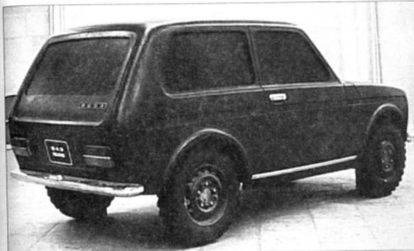
Доработка внешней формы в пластилине (для образцов третьей серии)
