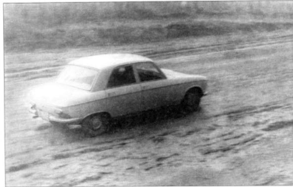
Лето 1967 г. Испытания тормозов на грунтовых дорогах автополигона
