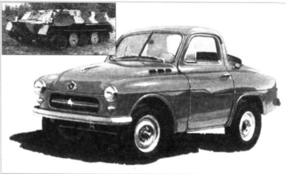
Опытный полноприводник ГАЗ-73 (уменьшенный вариант ГАЗ-72 с "москвичовскими" агрегатами). Не путать с серийным броневиком ГАЗ-73 (слева вверху)
