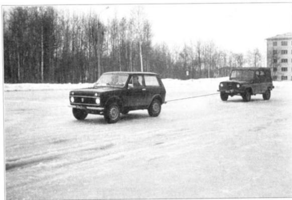
*Замер тягового усилия на льду (UAZ выполняет роль динамометрического прицепа)*
